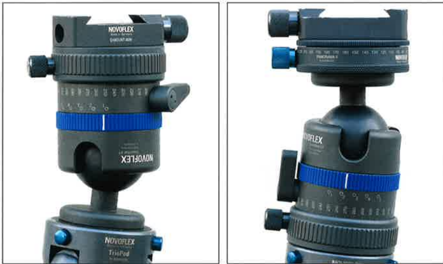
Einsparung: Eine zusätzliche Panoramaplatte (links) ist bei der kopfstehenden Montage (rechts) des ClassicBall überflüssig.
